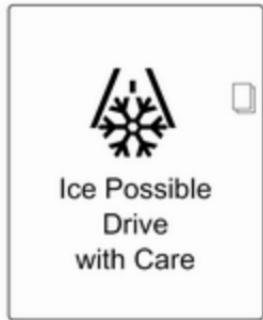
Окрім того, у центрі інформації для водіїв із дисплеєм вищого рівня відображається повідомлення з попередженням.
