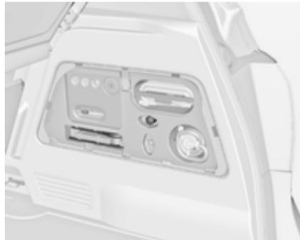
Набір інструментів зберігається в багажному відділенні справа разом із набором для ремонту шин.
