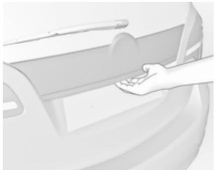
Після відімкнення натисніть сенсорний перемикач під молдингом і відкрийте багажник. Центральний замок ⌘ 22.
