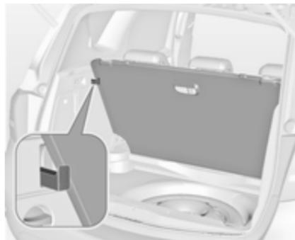
Знімна кришка полика в задній частині автомобіля піднімається.
