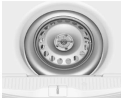
Запасне колесо розташоване в багажному відділенні під покриттям полика. Воно закріплене на місці крильчаткою гайкою.
