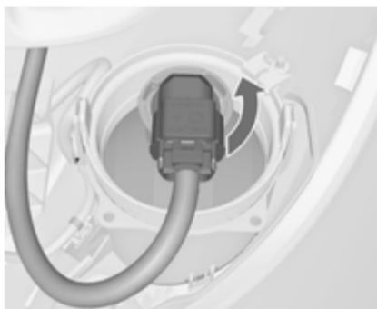
1. Поверніть тримач лампи проти годинникової стрілки та вийміть його з рефлектора.
