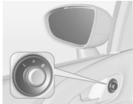
Виберіть потрібне зовнішнє дзеркало, повернувши регулятор уліво (L) чи вправо (R). Потім поверніть регулятор, щоб відрегулювати дзеркало.
