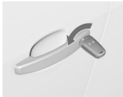
Розблокуйте вручну водійські дверцята за допомогою ключа. Щоб розблокувати всі дверцята, багажне відділення та кришку горловини паливного бака, увімкніть запалення й натисніть кнопку центрального замка. Якщо ввімкнути запалення, система запобігання викраденню автомобіля вимикається
