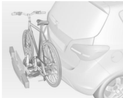
На задній системі кріплення багажу (система Flex-Fix) можна закріплювати велосипеди на витяжному тримачі, вбудованому в полик автомобіля.
