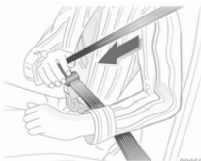
Витягніть пасок із переднатягувача, протягніть пасок безки по діагоналі через плече й грудну клітку (пасок не повинен перекручуватися) і вставте язичок защіпки в пряжку. Регулярно
