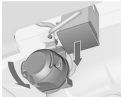
Відключіть та складіть розетку. Вийміть ущільнючу пробку з отвору для штанги та приберіть її.
