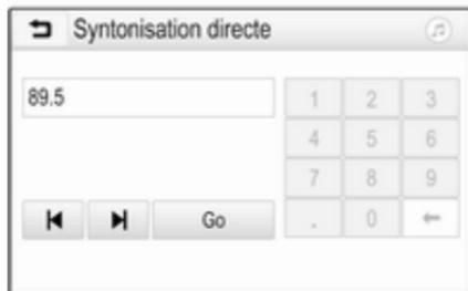
Saisir la fréquence désirée. Utiliser ← pour effacer les chiffres saisis. Si nécessaire, toucher ◀ ou ▶ pour régler l'entrée en conséquence.
