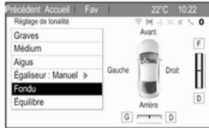
Pour régler la répartition du volume entre les haut-parleurs avant et arrière du véhicule, sélectionner **Fondu**. Effectuez le réglage désiré.
