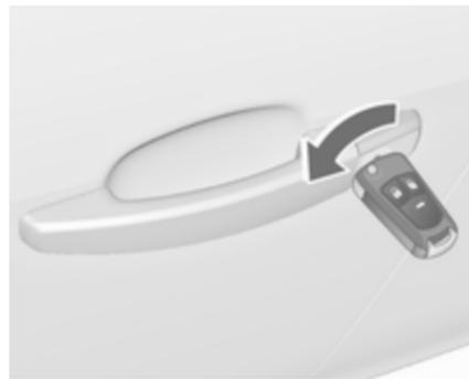
Déverrouiller manuellement la porte du conducteur en tournant la clé dans la serrure. Mettre le contact et appuyer sur le bouton de verrouillage central
