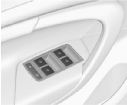
Appuyer sur le commutateur
