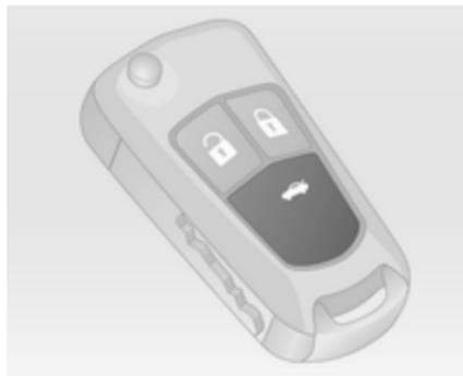
Le contact étant coupé, appuyer sur le bouton
