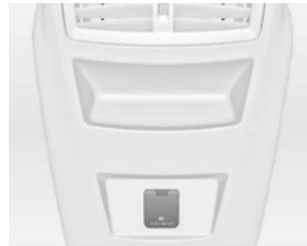
Une prise de courant 230 V est placée dans la console centrale arrière. Si le contact est mis et qu'un appareil est branché, une LED s'allume en vert dans la prise.
