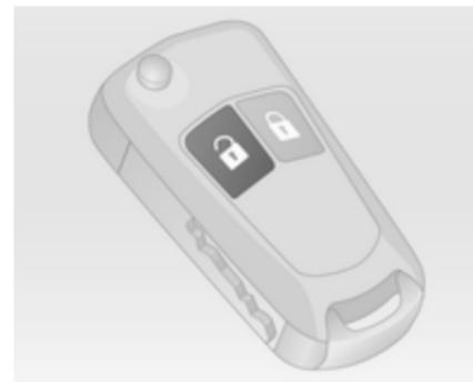
Appuyer sur le bouton
