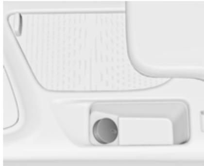
Des prises de courant 12 V sont présentes de la console centrale avant et arrière.
