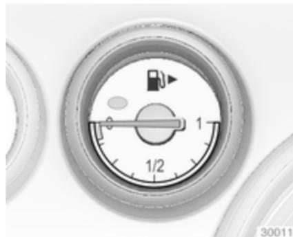
Indique le niveau de carburant dans le réservoir.
