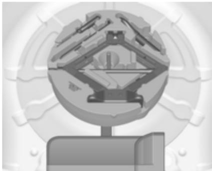
Le cric et les outils se trouvent dans un compartiment de rangement sous la roue de secours dans le coffre.
