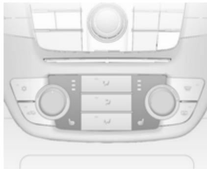
En fonction du niveau de chauffage voulu, appuyer une ou plusieurs fois sur le bouton
