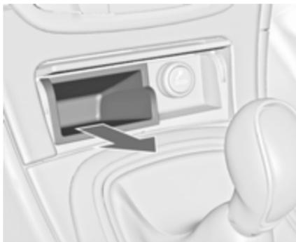
Pour vider le cendrier, appuyer sur les deux côtés de l'insert et le sortir.
