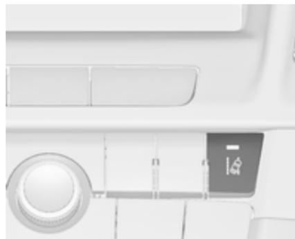
Quand le système détecte un changement de file inattendu, le témoin
