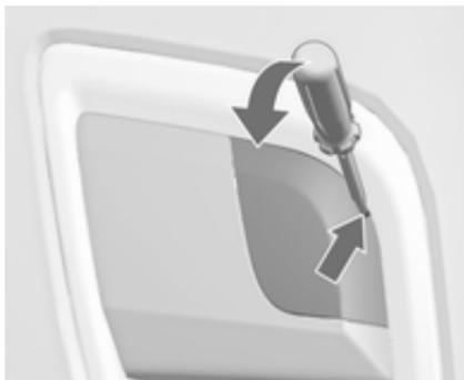
**Insignia OPC** : introduire le tournevis dans la fente de l'arrondi supérieur du capuchon. Dégager le capuchon en enfonçant avec précaution le tournevis vers le bas. Pour éviter tout dégât, il est recommandé de placer un chiffon entre le tournevis et le cadre.
