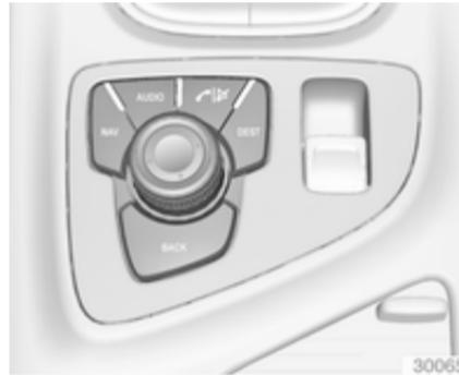
Sélectionner une fonction via les boutons de l'unité multifonction. Le menu de la fonction sélectionnée est affiché.
