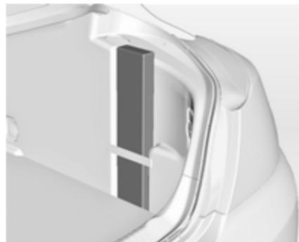
Ranger le triangle de présignalisation dans l'espace situé derrière la sangle sur le côté droit du coffre.
