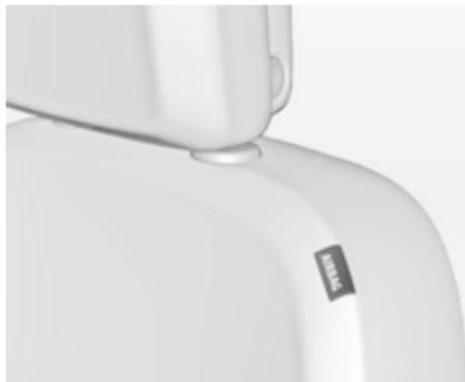
Le système d'airbag latéral se compose d'un airbag dans chacun des dossiers de siège avant et dans les dossiers des sièges arrière extérieurs. Ils sont reconnaissables à l'inscription **AIRBAG**.
