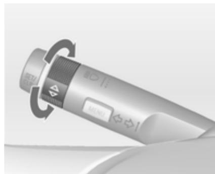
Les panneaux routiers sont affichés sur la page **Détection des panneaux routiers** dans le **Menu informations trajet/carbur.**, en sélectionnant avec la roue moletée de la manette des cli-gnotants ↻ 94.
