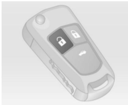
Appuyer sur le bouton
