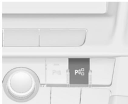
Lors de la recherche d'un emplacement de parking, le système doit être activé en appuyant sur le bouton **P**
