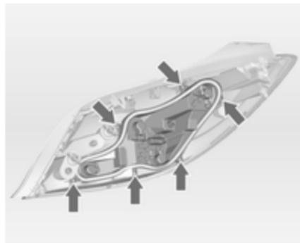
4. Dévisser les vis et enlever la douille d'ampoule.
