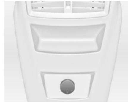
La puissance maximale absorbée ne doit pas dépasser 120 watts.
