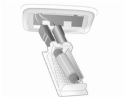
2. Sortir l'ampoule en la poussant légèrement dans la direction de la languette-ressort.
