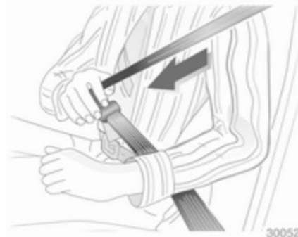
Tirer la ceinture hors de l'enrouleur, la guider sur le corps sans la vriller et insérer le verrou plat dans la serrure. En roulant, tendre régulièrement la sangle abdominale en tirant sur la sangle thoracique. Rappel de ceinture de sécurité ⇨ 88
