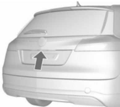
Pour ouvrir le hayon, pousser et maintenir le commutateur tactile sous la moulure de hayon jusqu'à ce que le hayon commence à se déplacer.
