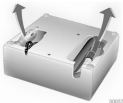
3. Enlever le câble de raccordement électrique et le flexible d'air de leur espace de rangement sur la face inférieure du compresseur.
