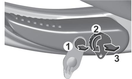
Fermer la serrure avec la clé en la tournant dans le sens anti-horaire et en tirant dessus.
