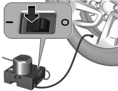
11. Placer le commutateur à bascule du compresseur sur **I**. Le pneu est rempli de produit d'étanchéité.
