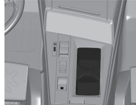
Pour régler la position du porte-gobelet, saisir l'élément coulissant et appuyer à fond sur le bouton central avec le pouce. Les porte-gobelets arrière se trouvent dans l'accoudoir entre les sièges. Abaisser l'accoudoir.
