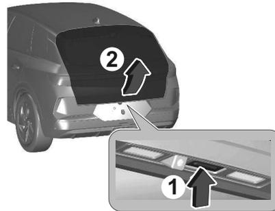
1. Appuyer sur le bouton derrière le bord central inférieur du hayon.
