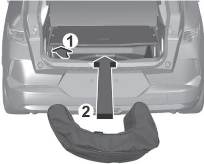
Soulever le double plancher de chargement et ranger le sac en plaçant la barre de la boule d'attelage en dessous et la bande velcro vers le bas afin d'assurer une bonne fixation du sac.
