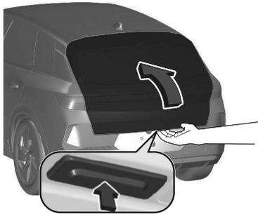
Pour ouvrir le hayon, appuyer sur le bouton du hayon sous la moulure de hayon et le maintenir enfoncé jusqu'à ce que le hayon commence à se déplacer. Si le véhicule est verrouillé, la clé électronique doit se trouver à l'extérieur du véhicule dans un rayon d'environ 1 m du hayon.
