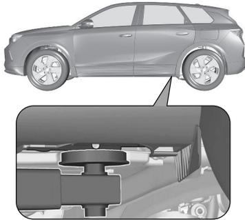
La position de bras arrière de la plateforme de levage est centrale sous le point concerné de levage du véhicule. Sur les véhicules BEV, il faut d'abord retirer le couvercle de protection.
