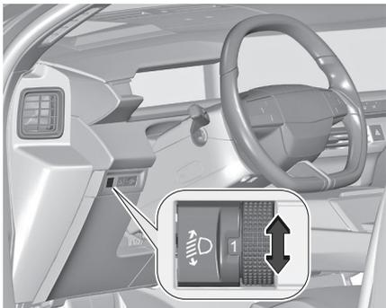
Pour adapter la hauteur des phares en fonction du chargement du véhicule afin d'éviter l'éblouissement : tourner la molette dans la position désirée.
