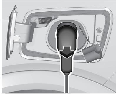
2. Débrancher du port de charge la fiche côté véhicule du câble de recharge dans les 30 secondes suivant le déverrouillage.
