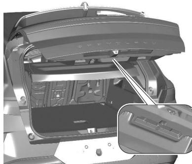
Ranger le triangle de présignalisation dans l'espace prévu à cet effet dans le hayon et le fixer au moyen de la bande Velcro®.
