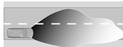
Activés automatiquement après un petit délai en cas de conduite à plus de 50 km/h en zones rurales. L'éclairage de la voie et du bas-côté est adapté. Les véhicules qui arrivent et qui précèdent ne sont pas éblouis.
