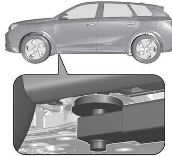
La position de bras avant de la plateforme de levage est centrale sous le point concerné de levage du véhicule.
