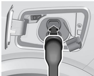
6. Brancher la fiche côté véhicule du câble de recharge dans le port de charge du véhicule.
