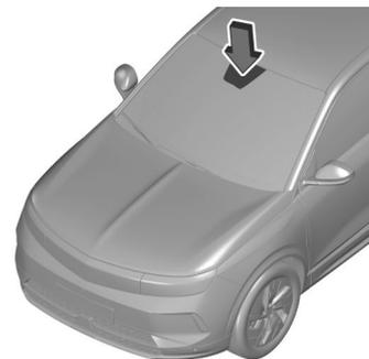
Ne pas fixer d'autocollants sur le pare-brise comme des autocollants de péage ou tout autre élément identique dans la zone du rétroviseur intérieur du pare-brise. Le champ du capteur de pluie doit rester propre, c'est-à-dire sans poussière, saletés, ni givre. Sinon, la zone de détection du capteur de pluie / capteur de luminosité et la zone de vision de la caméra dans le boîtier du rétroviseur peuvent être restreintes. ⇒page45
