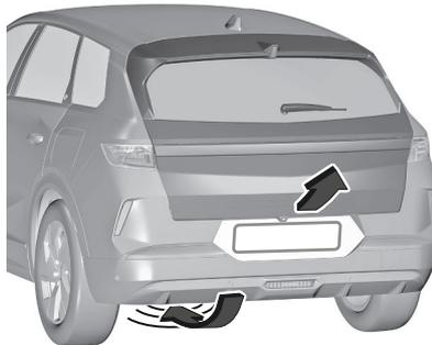
Pour ouvrir ou fermer le hayon, avancer et reculer le pied dans la zone illustrée. Ne pas laisser le pied trop longtemps ou le bouger trop lentement sous le pare-chocs. La clé électronique doit se trouver à l'extérieur du véhicule dans un rayon d'environ 1 m du hayon. Les feux de direction clignotent pour indiquer que le hayon motorisé est en mouvement. Le fonctionnement mains libres peut être réglé à l'écran d'information. Personnalisation du véhicule ⇒ page 76
