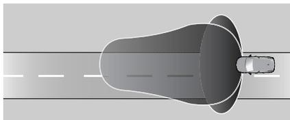
Activé automatiquement lorsque le véhicule se met en mouvement et tant qu'il n'a pas atteint la vitesse de 25 km/h. Ce feu est conçu pour améliorer la visibilité des piétons sur les côtés du véhicule.
