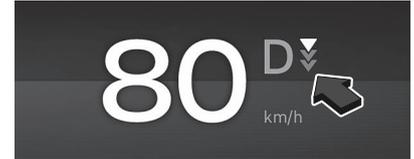
Le niveau de freinage est indiqué par un à trois segments en triangle au combiné.
