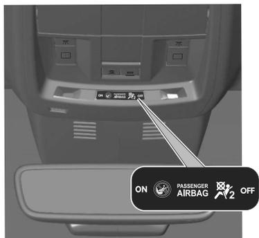
Si le témoin ON s'allume pendant environ 60 secondes après avoir mis le contact, le système d'airbag passager avant se déploiera en cas de collision.
