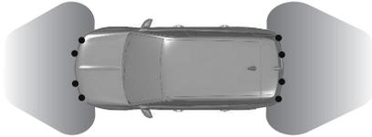
Le système possède des capteurs de stationnement à ultrasons dans les pare-chocs arrière et avant.
