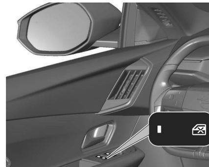
Appuyer sur le bouton pour désactiver les lève-vitres électriques des portes arrière. La LED s'allume. Pour l'activation, appuyer de nouveau sur le bouton.
