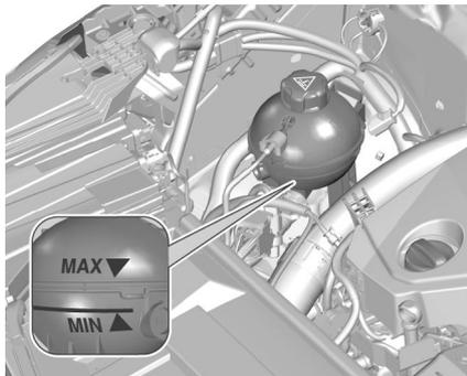
Si le niveau du liquide de refroidissement est au niveau du repère MIN ou en dessous, demander l'assistance d'un atelier pour faire l'appoint de liquide de refroidissement du moteur.
