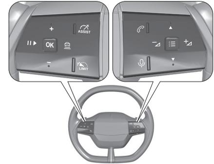
Certains systèmes d'assistance au conducteur, le système d'infodivertissement et un téléphone mobile connecté peuvent être actionnés via les commandes au volant. Systèmes avancés d'aide à la conduite ⇨ page148
