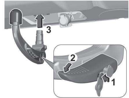
Insérer la barre d'attelage dans le logement et pousser fermement vers le haut jusqu'au déclic audible. La poignée doit s'encliqueter vers le haut.
