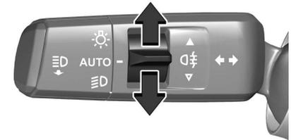
Pousser le commutateur vers le haut pour allumer le feu antibrouillard arrière. Pousser le commutateur vers le bas pour éteindre le feu antibrouillard arrière.
