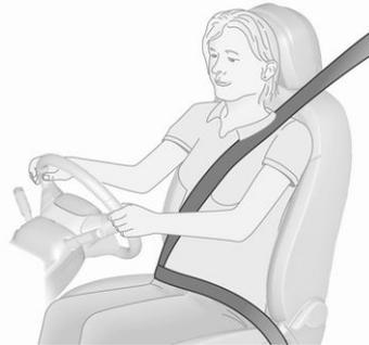
Les ceintures de sécurité sont bloquées lors d'accélération ou de décélération fortes du véhicule, ce qui assure le maintien des occupants en position
