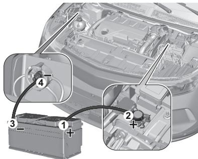
Ouvrir les capuchons de protection de la borne positive des deux batteries du véhicule.
