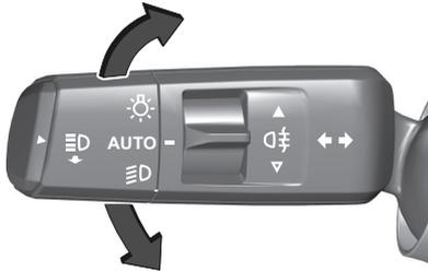
Quand le véhicule est stationné, les feux de stationnement peuvent être allumés d'un côté :
