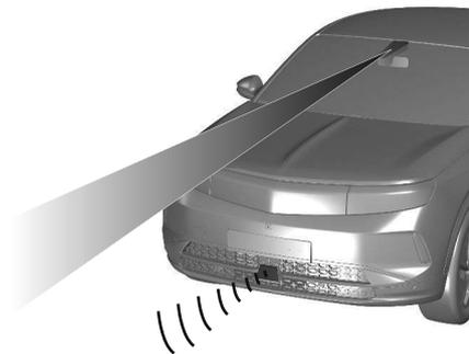
Le système activé repère les marquages de la voie à l'aide de la caméra placée en haut du pare-brise. Il dirige le véhicule à l'intérieur de la voie détectée. Le conducteur remarque un mouvement de rotation du volant.
