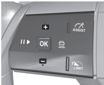
La vitesse présélectionnée peut être modifiée en appuyant sur + pour l'augmenter ou sur - pour la diminuer. Une pression courte modifie la vitesse de 1 km/h. Une pression longue modifie la vitesse de 5 km/h.
