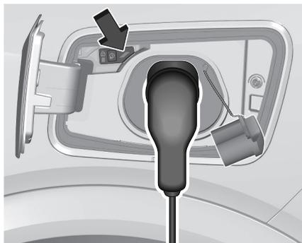
Le début de la charge est indiqué par le clignotement en vert de l'indicateur d'état sur le port de charge et sur son boîtier de commande, le cas échéant.
