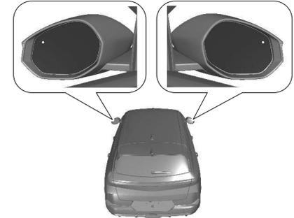
Lorsque le système détecte un véhicule dans la zone aveugle en roulant en avant, une diode s'allume dans le rétroviseur concerné. Si les feux de direction du côté approprié sont activés, la LED clignote.
