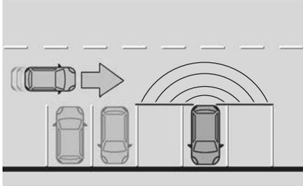
Le système détecte des obstacles qui se déplacent à une vitesse supérieure à 3 km/h et à une distance maximale de 40 m.
