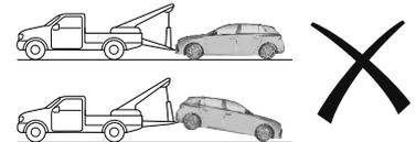
Pour remorquer le véhicule, toujours dégager les roues non motrices du sol.
