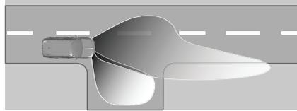
Activé à une vitesse allant jusqu'à environ 40 km/h lors du changement de direction. En fonction de l'angle du volant et des clignotants, une fonction d'éclairage DEL particulière est déclenchée, qui éclaire le sens de la marche.
