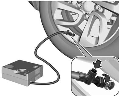
17. Reprendre la route sans délai afin que le produit d'étanchéité se répartisse uniformément dans le pneu. Rouler entre 20 km/h et 60 km/h. Après un trajet d'environ 5 km, mais pas plus de dix minutes, s'arrêter et contrôler la pression des pneus. À cet effet, visser directement le flexible d'air sur la valve du pneu. Remplir le pneu comme décrit ci-avant. Réduire l'excédent de pression
