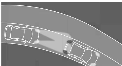
En entrant dans une zone éclairée, les segments lumineux s'atténuent progressivement de l'extérieur vers l'intérieur et passent en feux de croisement.
