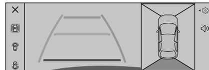
Différentes vues peuvent être sélectionnées dans la partie gauche de l'affichage. Changer le type de vue à tout moment pendant une manœuvre en sélectionnant une vue du côté gauche :
