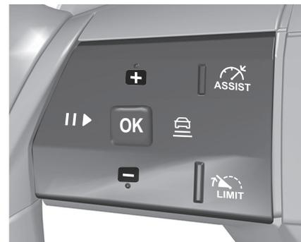
La vitesse mémorisée peut être modifiée en déplaçant le bouton + ou - pour augmenter la vitesse ou sur le bouton - pour la réduire. Déplacer la molette à plusieurs reprises pour modifier la vitesse par petits incréments ; déplacer et maintenir pour modifier la vitesse par grands incréments.
