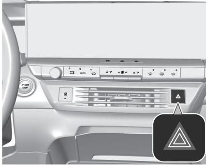
Appuyer sur le bouton pour les allumer. En cas de freinage dans une situation d'urgence, les feux de détresse s'allument automatiquement en fonction de l'intensité de la décélération. Lorsque le véhicule redémarre, il faut désactiver les feux de détresse manuellement.
