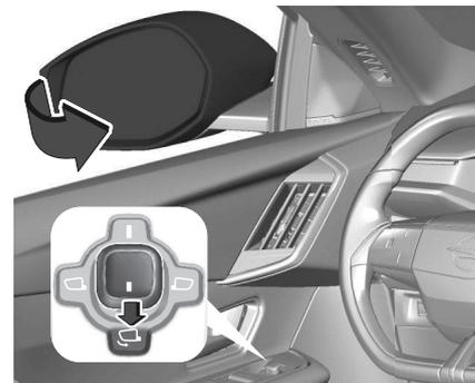
Pour rabattre ou déployer les deux rétroviseurs extérieurs, sélectionner la fonction de rabattement en tournant la commande sur
