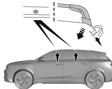
Les barres transversales doivent être fixées exclusivement aux quatre points d'ancrage situés sur le cadre de pavillon. Ces points sont masqués par les portes du véhicule lorsque les portes sont fermées.
