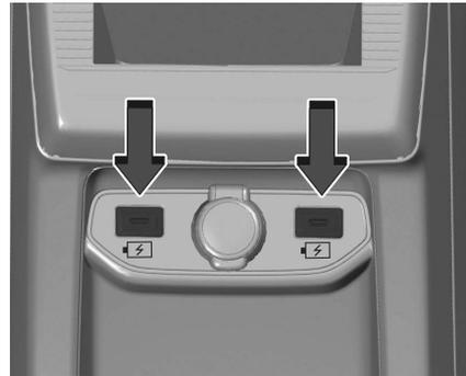
Le port USB peut être utilisé pour le chargement d'un appareil portable.
