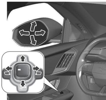
Sélectionner le rétroviseur extérieur souhaité en tournant la commande. Ensuite, faire pivoter la commande pour régler le rétroviseur sélectionné.
