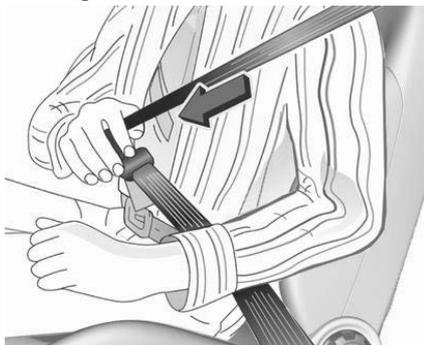
Tirer la ceinture de sécurité hors de l'enrouleur, la guider sur le corps sans la vriller et insérer la languette de verrouillage dans la boucle. S'assurer que la ceinture de sécurité soit placée en travers de l'épaule et qu'elle est bien ajustée au corps pendant la conduite.
