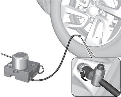
8. Visser le flexible de remplissage sur la valve du pneu.
