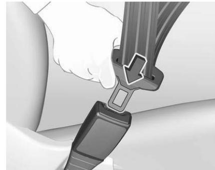
Le port de vêtements larges ou épais gêne la position tendue de la ceinture de sécurité. Ne pas placer d'objets, comme un sac à main ou un téléphone portable, entre la ceinture de sécurité et le corps.
