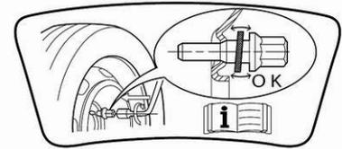
10. Si le véhicule est équipé de jantes en alliage, noter que les vis de roue peuvent également être utilisées pour la jante de roue de secours. Dans ce cas, le serrage de la roue de secours est assuré par le contact conique de chaque tête de vis.
