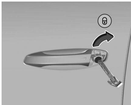
Verrouiller manuellement la porte avant gauche en introduisant et en tournant la clé dans le barillet de la serrure. Si le système de verrouillage centralisé est opérationnel, le véhicule sera verrouillé.
