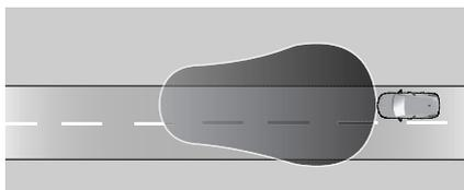
Activés automatiquement à une vitesse inférieure à 25 km/h et désactivés après quelques secondes lorsque la vitesse du véhicule dépasse 50 km/h. Le faisceau lumineux est large pour mieux reconnaître les dangers sur la route, comme les piétons et les croisements.
