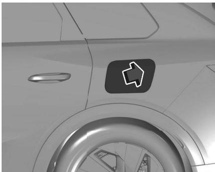
2. Pousser le volet du port de charge au niveau des deux "repère/bandes" situés au centre arrière du volet.
