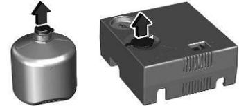
4. Ouvrir la bouteille de produit d'étanchéité et lever le couvercle.
