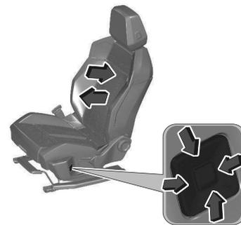
Régler le soutien lombaire en utilisant le commutateur à quatre positions pour qu'il s'adapte à vos souhaits personnels. Maintenir enfoncé l'avant ou l'arrière du commutateur pour augmenter ou diminuer le soutien lombaire. Maintenir enfoncé le haut ou le bas du commutateur pour relever ou abaisser le soutien lombaire.
