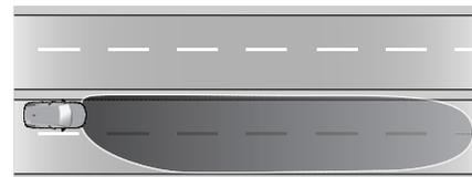
Activé automatiquement avec les feux de route anti-éblouissement et lorsque la conduite sur autoroute est détectée. L'éclairage est adapté pour éviter d'éblouir le trafic venant en sens inverse, qui peut être partiellement caché par des séparations en bordure de route.
