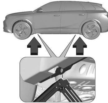
1. Vérifier que le cric est bien positionné sous le point de levage adéquat.
