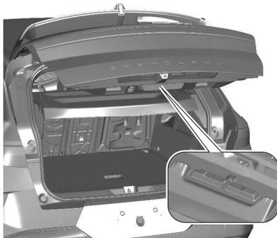
Ranger le triangle de présignalisation dans l'espace arrière de la porte de coffre et le fixer au moyen de la bande Velcro®.
