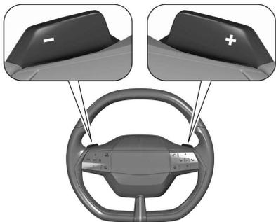
Appuyer sur la palette gauche - pour diminuer la force de freinage et sur la palette droite + pour l'augmenter. Utiliser la force de freinage maximale dans les fortes pentes, dans la neige profonde, dans la boue ou arrêts/démarrages fréquents.
