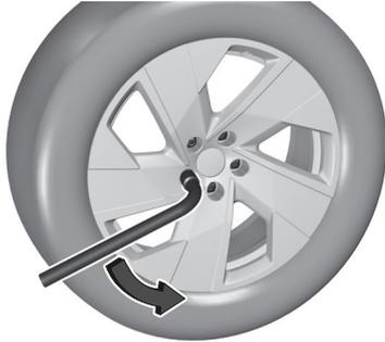
Placer la clé de roue et desserrer chaque boulon de roue d'un demi-tour.
