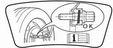
Noter que la roue de secours est fixée par le contact conique de chaque boulon si des boulons de roue sont utilisés pour les jantes en alliage. Dans ce cas, les rondelles ne viennent pas en contact avec la jante de roue de secours.
