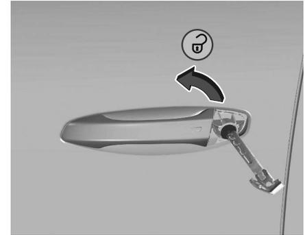
Insérer la clé dans le barillet de serrure et la tourner dans le sens anti-horaire.
