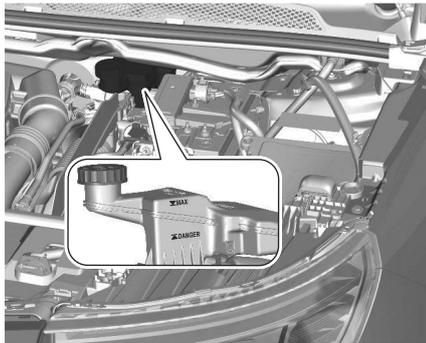
Le niveau de liquide de frein doit se situer entre les repères **MIN** et **MAX**. Si le niveau de liquide est en dessous du niveau **MIN**, contacter un atelier.
