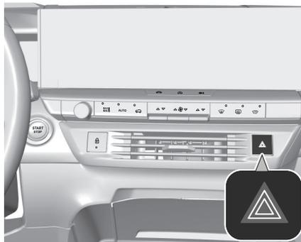
Appuyer sur le bouton pour les allumer. En cas de freinage dans une situation d'urgence, les feux de détresse s'allument automatiquement en fonction de l'intensité de la décélération.
