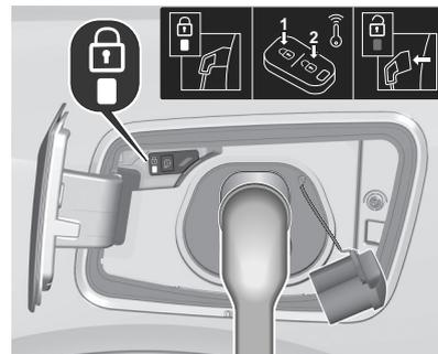
Pendant la recharge, la fiche du véhicule est verrouillée sur le port de charge et ne peut être débranchée en cours de recharge. Le voyant
