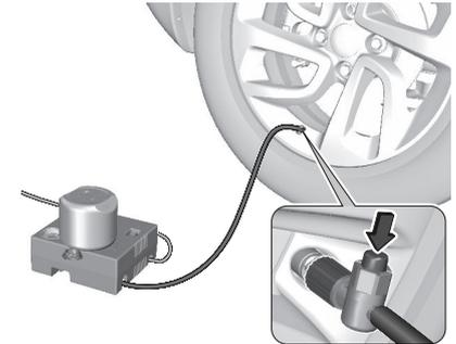
Réduire l'excédent de pression de pneu au moyen du bouton du flexible pneumatique.
