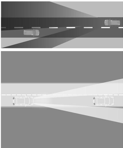
Le faisceau est adapté dynamiquement en fonction des conditions de conduite. La répartition de l'éclairage est ainsi optimale, sans éblouir les autres usagers de la route.
