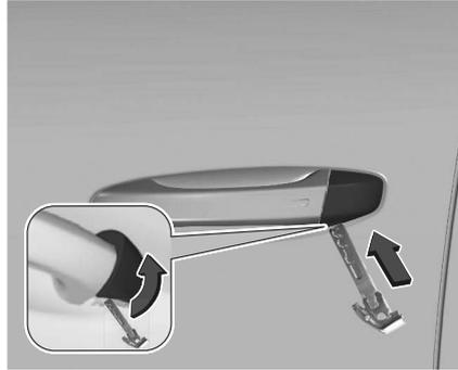
Le barillet de serrure de la porte conducteur est recouvert d'un capuchon. Pour déposer le capuchon, extraire la lame de clé intégrée de son logement. Introduire la clé dans le renforcement au bas du capuchon et faire pivoter la clé vers le haut.
