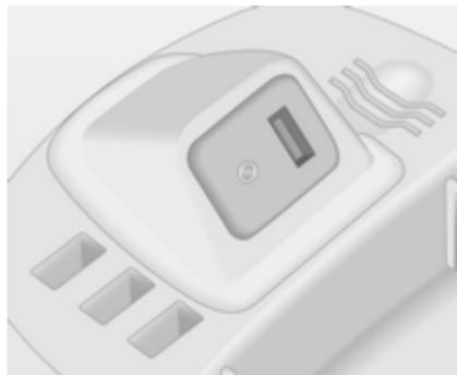
Sur la console centrale, à l'avant du levier de changement de vitesse, se trouve une prise USB pour la connexion de sources de données audio externes.
