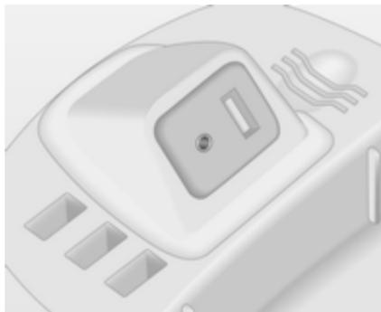
Sur la console centrale, à l'avant du levier de changement de vitesse, se trouve une prise AUX pour la connexion de sources audio externes.
