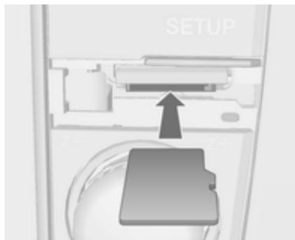
Poussez avec précaution, la carte SD avec la face portant l'étiquette sur le haut, et les découpes sur le côté droit (voir image ci-dessus) dans la fente jusqu'à ce que la carte s'engage.
