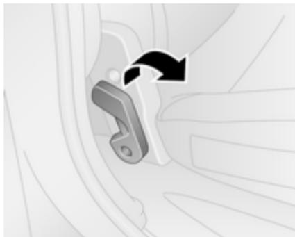
Tirer la manette pour déverrouiller, le socle du siège est sous tension et commencera à soulever automatiquement.
