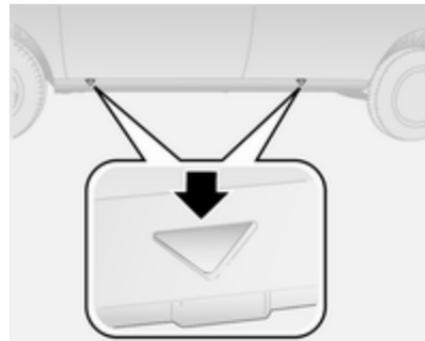
3. Les points de levage du véhicule sont situés à l'avant et à l'arrière.
