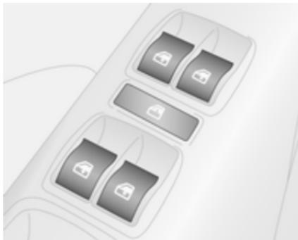
Appuyer sur le bouton
