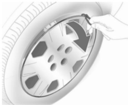
1. Dégager et retirer les capuchons des écrous de roue à l'aide d'un tournevis. Soulever et enlever l'enjoliveur à l'aide d'un outil adéquat.
