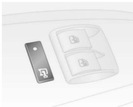
Appuyer sur le bouton
