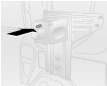
3. Placer la roue qui a été remplacée sur le support en veillant à l'alignement correct de la goupille de positionnement.
