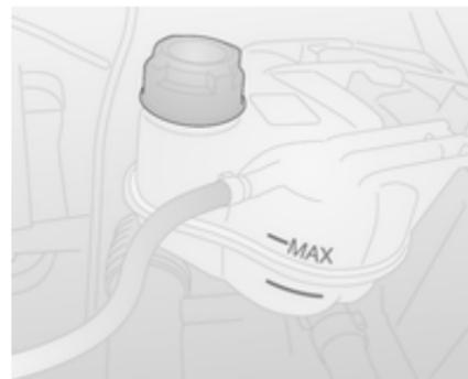
Si le circuit de refroidissement est froid, le niveau de liquide de refroidissement doit se trouver entre les repères **MIN** et **MAX**. Faire l'appoint si le niveau est bas.
