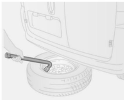
4. Sortir la roue de secours du dessous du véhicule.
