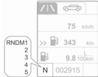
En mode automatique, le programme de conduite est signalé par **D** sur le centre d'informations du conducteur.
