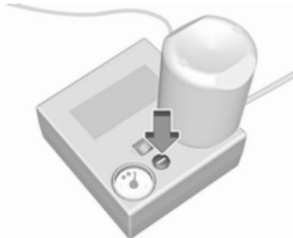
Si la pression des pneus prescrite n'est pas atteinte dans les dix minutes, démonter le kit de réparation de pneus. Avancer ou reculer le véhicule d'un tour de roue. Brancher à nouveau le kit de réparation des pneus et poursuivre la
