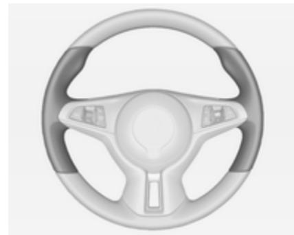
Les zones mises en relief pour tenir le volant sont chauffées plus rapidement et à une température plus élevée que le reste du volant.
