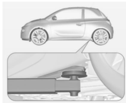
Positionner le bras arrière du pont élévateur, positionné centralement sous le creux du seuil.
