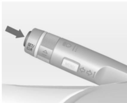
Sélectionner une place de stationnement parallèle ou perpendiculaire dans le centre d'informations du conducteur en appuyant sur SET/CLR.
