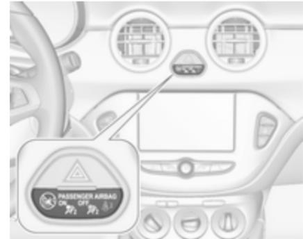
Si le témoin  $\text{OFF}$  s'allume pendant environ 60 secondes après avoir mis le contact, le système d'airbags de passager avant se déploiera en cas de collision.
