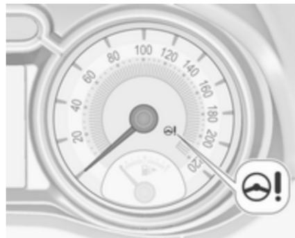
En cas de défaillance dans le système,
