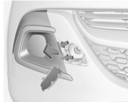
2. Déposer le cache en tirant avec les doigts sur les positions indiquées, voir les flèches sur l'illustration.
