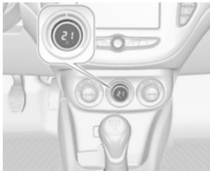
Si la température minimale **Lo** est réglée, le système de commande de climatisation fonctionne avec sa capacité maximale de refroidissement, si le refroidissement
