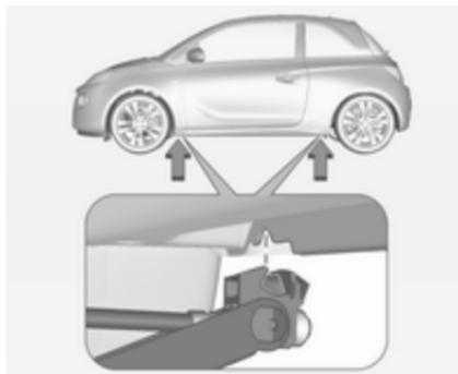
3. Vérifier que le cric est bien positionné sous le point de levage adéquat.
