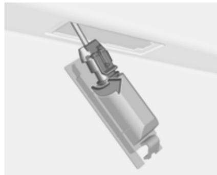
2. Sortir l'ampoule par le bas en veillant à ne pas tirer sur le câble.
