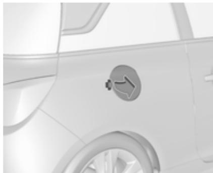
La trappe de réservoir ne peut être ouverte que lorsque le véhicule est déverrouillé.
