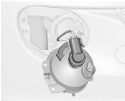
4. Désengager et retirer la douille en tournant dans le sens anti-horaire.
