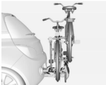
Le système de transport arrière (système Flex-Fix) permet de fixer une bicyclette au support de transport extensible intégré dans le plancher du véhicule. Il est possible de fixer un vélo supplémentaire sur un adaptateur. Le transport d'autres objets n'est pas autorisé.
