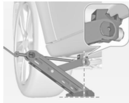
4. Régler le cric à la hauteur nécessaire. Le positionner juste au-dessous du point de levage de manière telle qu'il ne puisse pas glisser.
