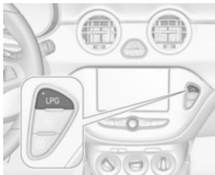
L'actionnement de **LPG** permet le basculement entre les modes de fonctionnement à l'essence et au gaz de pétrole liquéfié dès que les paramètres requis (température de liquide de refroidissement et régime moteur minimal) ont été atteints. Les exigences sont généralement satisfaites après environ 60 secondes (en fonction de la température extérieure) et la première pression ferme sur la
