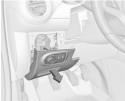
La boîte à fusibles se trouve derrière le commutateur d'éclairage du tableau de bord.
