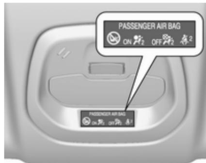
Si el testigo de control ON se ilumina durante unos 60 segundos después de conectar el encendido, los sistemas de airbag del asiento del acompañante se inflarán en caso de colisión.
