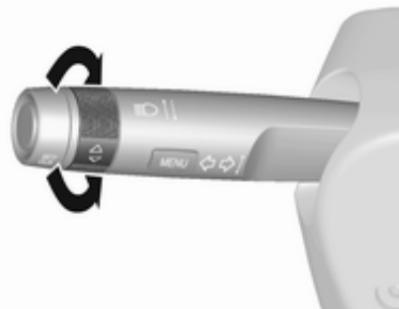
Gire la rueda de ajuste para seleccionar un submenú del menú principal o ajustar un valor numérico.
