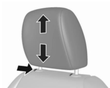
Pulse el botón de desbloqueo, ajuste la altura y enclave.
