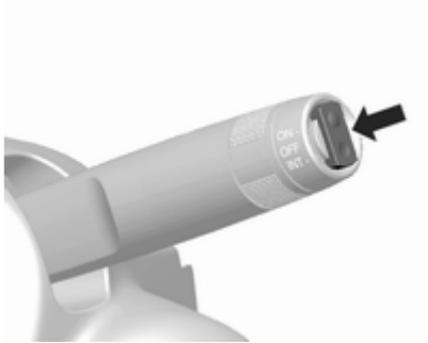
Pulse el interruptor basculante para activar el limpiavientos:
