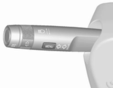
Pulse **MENU** para cambiar entre los menús principales o para volver de un submenú al siguiente nivel superior del menú.
