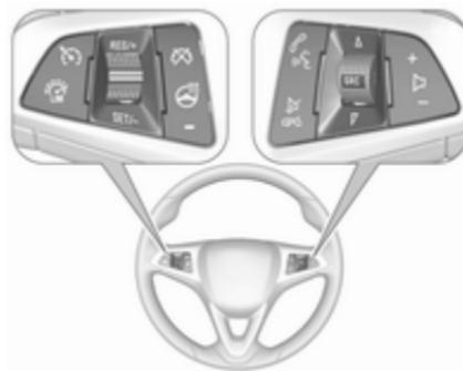
El regulador de velocidad y el limitador de velocidad se utilizan con los mandos del lado izquierdo del volante.
