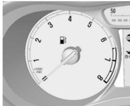
El testigo de control
