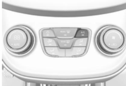
Pulse **A/C** para activar la refrigeración. El LED del botón se ilumina para indicar su activación. La refrigeración
