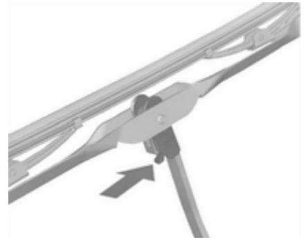
Levante el brazo del limpiaparabrisas. Pulse la palanca de desbloqueo y desacople la escobilla.
