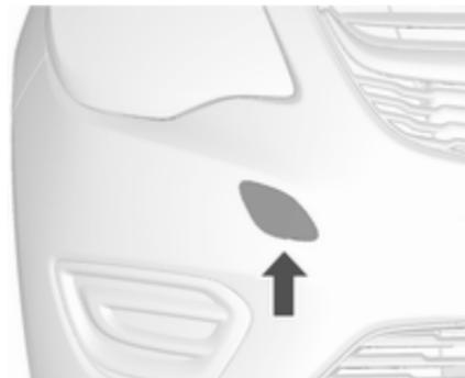
1. Envuelva un trapo alrededor de la punta de un destornillador plano para evitar dañar la pintura. Desenclave la tapa usando el destornillador y desmóntela.
