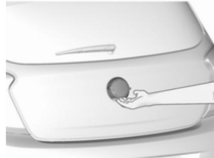
Para abrir el portón trasero con todas las puertas desbloqueadas, pulse el interruptor del panel táctil en la parte inferior de la manilla del portón trasero y levante el portón trasero.
