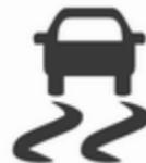
El ESC está operativo cada vez que arranca el motor en cuanto se apaga el testigo de control
