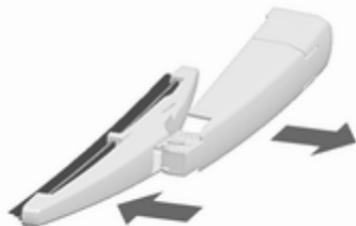
Levante el brazo del limpiaparabrisas. Presione la escobilla ligeramente inclinada respecto al brazo del limpiaparabrisas y empújela hasta que se desacople.
