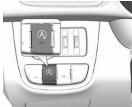
Desactive manualmente el sistema stop-start pulsando (A). Para indicar la desactivación, se apaga el LED del botón.
