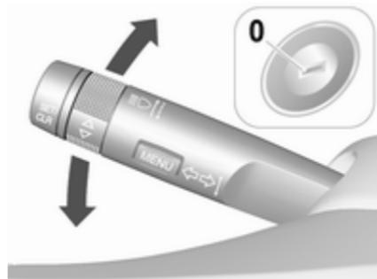
Cuando el vehículo está aparcado, se pueden activar las luces de estacionamiento de un lado:
