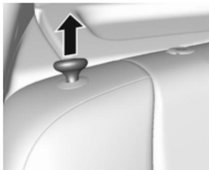
4. Tire del mando de desbloqueo en la parte superior del respaldo trasero.
