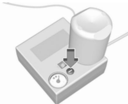
Vacíe el exceso de presión de los neumáticos mediante el botón situado encima del indicador de presión.
