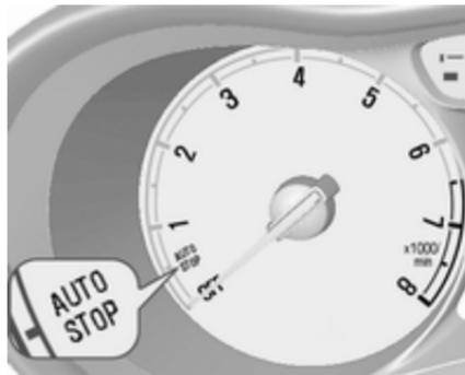
Si el vehículo circula a baja velocidad o está parado y se cumplen determinadas condiciones, active la función de parada automática Autostop del siguiente modo:
