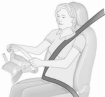
Al acelerar o frenar bruscamente el vehículo, los cinturones de seguridad se bloquean para sujetar a los ocupantes en la posición de asiento. De este modo se reduce considerablemente el riesgo de lesiones.
