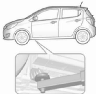
Posición del brazo trasero de la plataforma de elevación en los bajos del vehículo.
