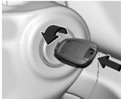
2. Presione la llave completamente hacia la columna de dirección y, después, gire la llave a la posición **0**.
