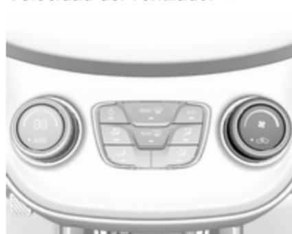
Ajuste el caudal de aire conectando la velocidad deseada del ventilador. La velocidad del ventilador seleccionada se indica mediante el número de segmentos en la pantalla. Si se desconecta el ventilador, el aire acondicionado también se desactiva.
