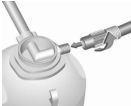
4. Enrosque el tubo flexible del compresor a la conexión del bote de sellador.
