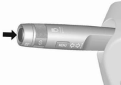
Pulse **SET/CLR** para seleccionar una función o para confirmar un mensaje. Los mensajes del vehículo y servicio son emergentes en el centro de información del conductor si es necesario. Confirme mensajes pulsando **SET/CLR**.
