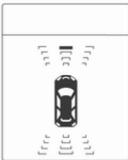
La distancia hasta un obstáculo delante y detrás se muestra mediante líneas de distancia cambiantes en el centro de información del conductor.
