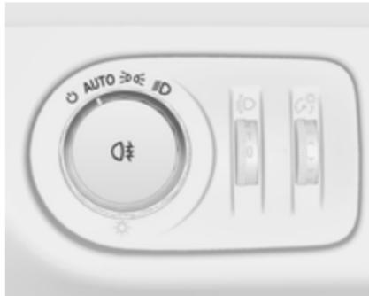
AUTO : Control automático de las luces: la iluminación exterior se enciende y apaga automáticamente
