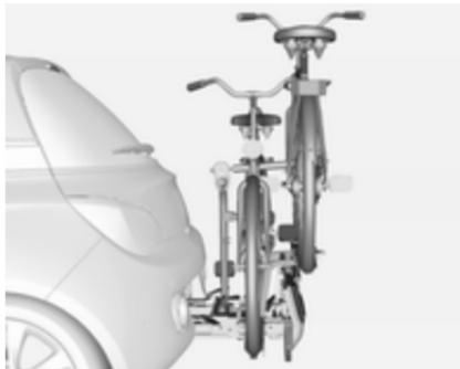
El portabicicletas trasero (sistema Flex-Fix) ofrece la posibilidad de fijar una bicicleta en un soporte extensible integrado en el piso del vehículo. Se puede fijar una bicicleta adicional sobre un adaptador. No se permite el transporte de otros objetos.
