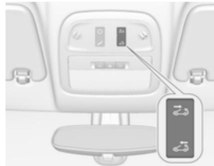
El interruptor se puede accionar de dos maneras: pulsación corta para funcionamiento automático y mantenimiento pulsado para funcionamiento manual.
