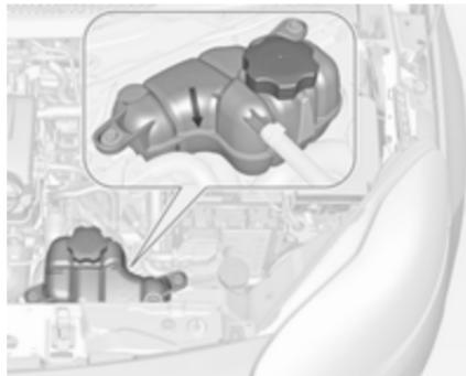
Con el sistema de refrigeración frío, el nivel del refrigerante debe estar por encima de la marca de la línea de llenado. Rellene si el nivel es más bajo.
