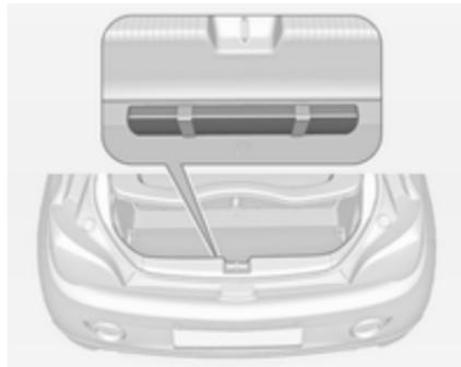
El triángulo de advertencia se guarda con correas elásticas en el compartimento de carga, debajo del portón trasero.
