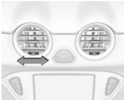
Ajuste el caudal de aire de la salida de ventilación girando la rueda de ajuste. La salida se cierra cuando la rueda de ajuste está girada a tope hacia la izquierda o la derecha.
