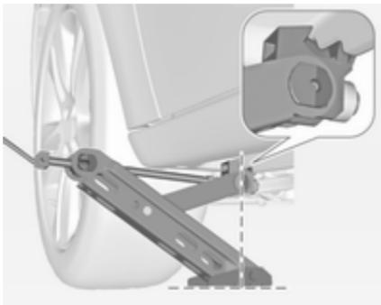
4. Ajuste el gato a la altura necesaria. Coloque el gato directamente debajo del punto de elevación, de modo que no pueda resbalar.
