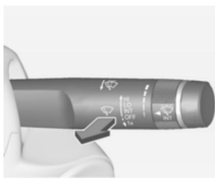
Tire de la palanca. Se pulveriza líquido de lavado sobre el parabrisas y el limpialuneta se realiza el barrido varias veces.
