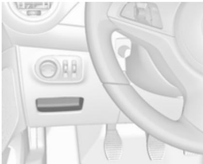
Hay compartimentos portaobjetos situados debajo del comutador de las luces, en la consola central delante de la palanca selectora, en los bolsillos de las puertas y en los paneles laterales junto a los asientos traseros.
