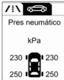
Gire la rueda de ajuste para seleccionar el sistema de control de presión de los neumáticos.
