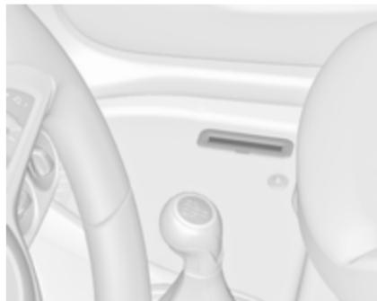
El número de identificación del vehículo está estampado en la placa de características y en el panel del piso, debajo de la cubierta del piso, visible bajo una tapa.
