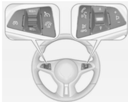
El sistema de infoentretenimiento, el regulador de velocidad y un teléfono móvil conectado pueden manejarse con los mandos en el volante.
