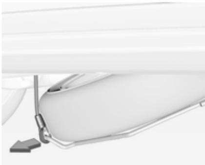
6. Levante un poco el soporte de la rueda de repuesto con la mano y suelte el cable de seguridad.
