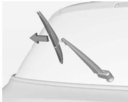
Levante el brazo del limpialuneta. Desacople la escobilla como se muestra en la ilustración y desmóntela.
