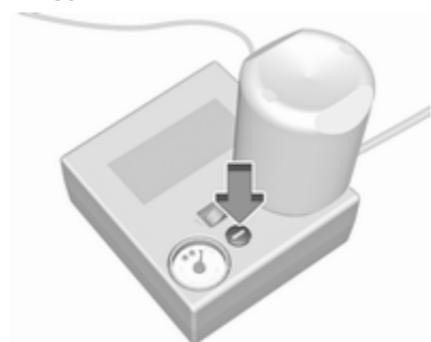
Si la presión prescrita no se alcanza en un plazo de diez minutos, desconecte el juego de reparación de neumáticos. Haga girar el neumático una vuelta completa. Vuelva a conectar el juego de reparación de
