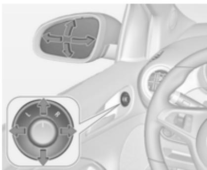
Seleccione el retrovisor exterior correspondiente girando el mando a la izquierda (L) o a la derecha (R). Luego bascule el mando para ajustar el retrovisor.
