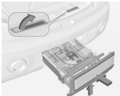
Mantenga levantada la palanca de desbloqueo. Suba ligeramente el sistema e introduzcalo en el parachoques hasta que quede enclavado.
