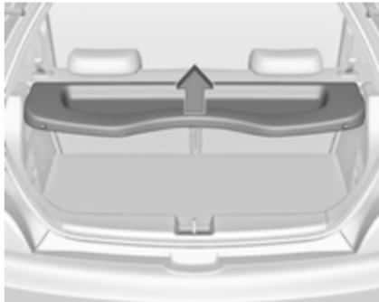
Levante la cubierta por el extremo trasero. Se enclava casi en posición vertical. Se puede abrir más. Para cerrarla, baje la cubierta más allá del punto de enclavamiento.
