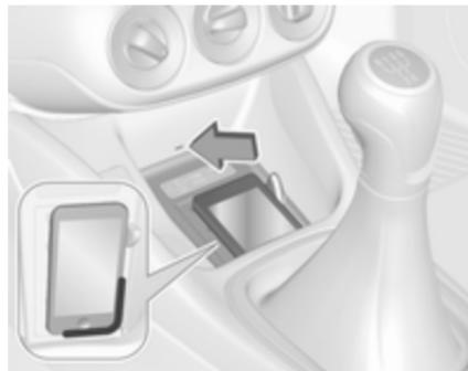
Para cargar un dispositivo, debe estar conectado el encendido.
