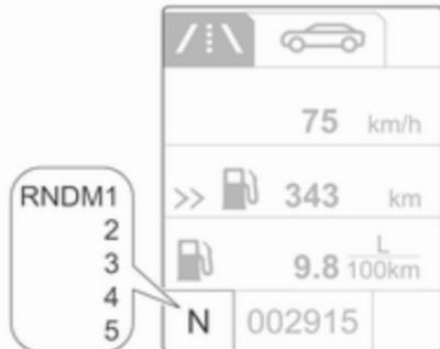
En modo automático, el programa de conducción se indica mediante **D** en el Centro de información del conductor.
