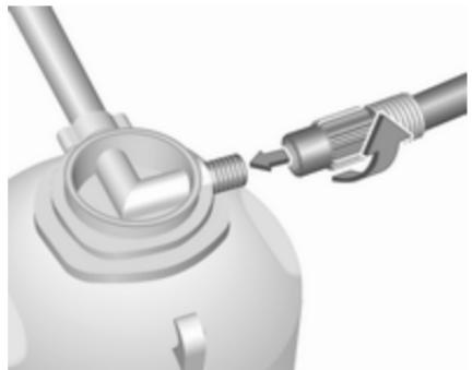
4. Enrosque el tubo flexible de aire del compresor a la conexión en el bote de sellador.
