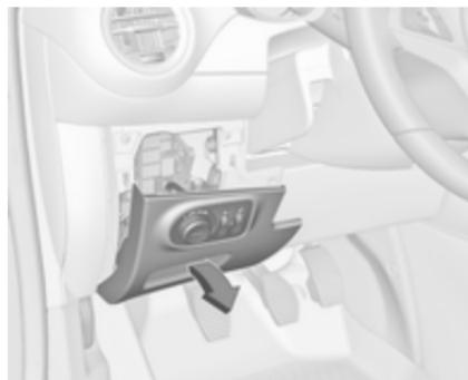
La caja de fusibles está detrás del interruptor de las luces en el tablero de instrumentos.
