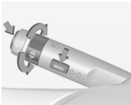
Pulse MENU para cambiar entre menús o para volver de un submenú al siguiente nivel superior del menú.
