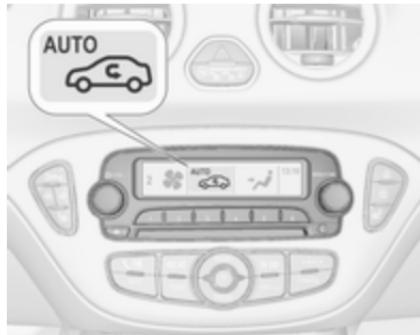
Los ajustes de la climatización se muestran en la pantalla de información. Las modificaciones de ajuste se muestran brevemente, superimpuestas sobre el menú que se muestra actualmente.
