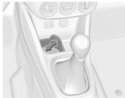
Hay una correa de goma flexible situada en el compartimento portaobjetos situado delante de la palanca selectora de cambios. Tire de la correa para sujetar un vaso o un cenicero.
