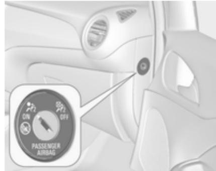
El sistema del airbag del acompañante delantero puede desactivarse con un interruptor accionado por llave situado en el lado del acompañante del panel de instrumentos.
