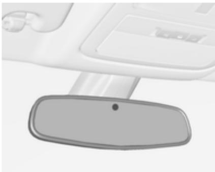
Se reduce automáticamente el deslumbramiento de los vehículos que tiene detrás por la noche.
