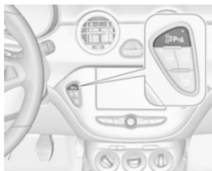
Cuando busque un hueco para aparcar, el sistema está listo para funcionar con una pulsación prolongada de
