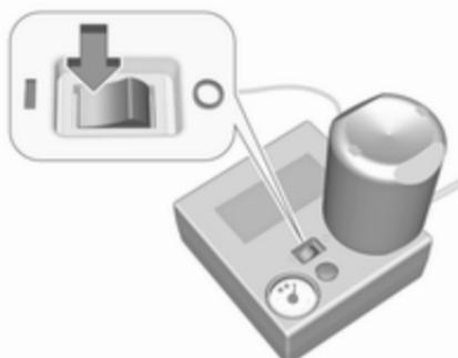
10. Ponga el interruptor basculante del compresor en I. El neumático se llenará con el sellador.
