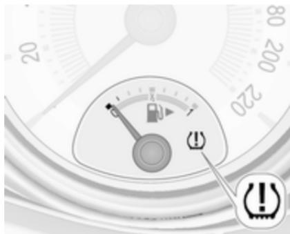
Si se detecta un problema de presión baja de los neumáticos, se indica mediante el testigo de control ▷ 93.
