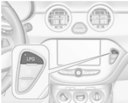
Pulse **LPG**. El LED del botón muestra el modo de funcionamiento actual.
