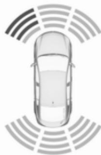
La distancia hasta los obstáculos se muestra en la pantalla de información en color mediante zonas de colores delante y detrás del vehículo  $\Rightarrow$  100.
