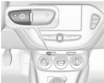
Pulse ☀ para activar la refrigeración. El LED del botón se ilumina para indicar su activación. La refrigeración
