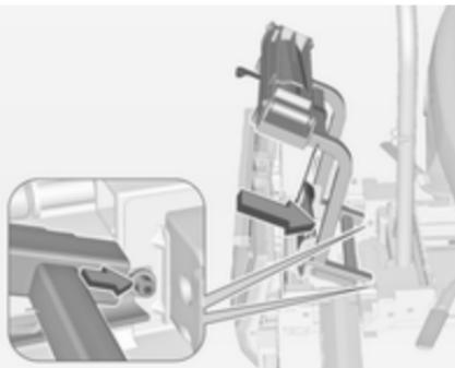
1. Monte el adaptador en el portabicicletas trasero tal y como se indica en la ilustración.
