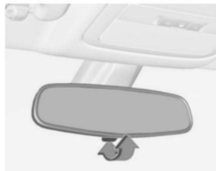
Para reducir el deslumbramiento, ajuste la palanca de la parte inferior de la carcasa del espejo retrovisor hacia delante o hacia atrás. La palanca en la posición intermedia es la posición de conducción normal.
