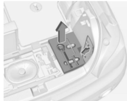
Para acceder a la tapa derecha en el compartimento de carga (por ejemplo, para la sustitución de bombillas), pliegue el respaldo trasero derecho y extraiga la caja de herramientas que hay junto al subwoofer.
