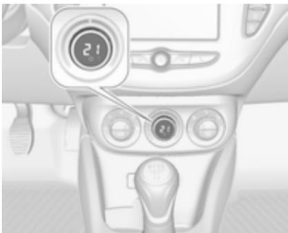
Si se ajusta la temperatura mínima **Lo**, el climatizador automático funciona a la máxima potencia de refrigeración siempre que se conecte la refrigeración
