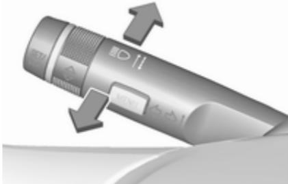
Para cambiar de luz de cruce a luz de carretera, pulse la palanca.
