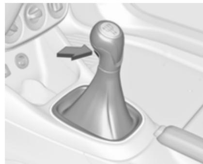
Marcha atrás: con el vehículo parado, pise el pedal de embrague y pulse el botón de desbloqueo de la palanca selectora y engrane la marcha.
