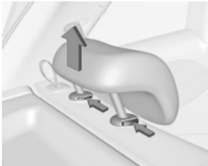
Presione los dos fiadores, tire del reposacabezas hacia arriba y desmóntelo.
