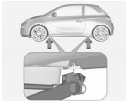
3. Asegúrese de que el gato está bien colocado en el punto de elevación correspondiente del vehículo.
