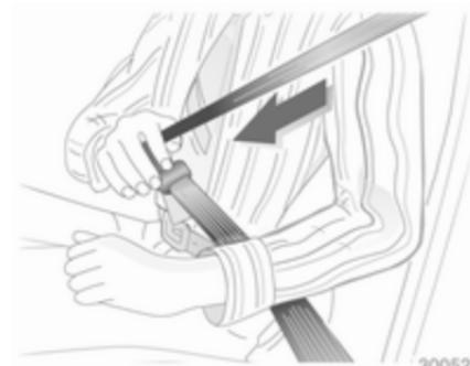
Extraiga el cinturón del retractor, guélo por encima del cuerpo sin retorcerlo e inserte la lengüeta en el cierre. Durante el viaje, tense frecuentemente el cinturón abdominal tirando suavemente de la banda torácica.
