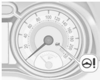
En caso de avería en el sistema, se ilumina y aparece un mensaje en el centro de información del conductor.
