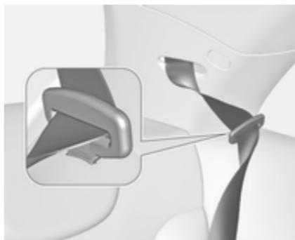
Inserte la lengüeta del cinturón de seguridad en el alojamiento lateral para proteger el cinturón de posibles daños.
