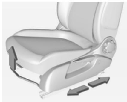
Tire del asidero, deslice el asiento, suelte el asidero. Intente mover el asiento hacia delante y hacia atrás para asegurarse de que el asiento está bloqueado en su posición.
