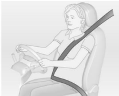
Extraiga el cinturón de seguridad y abroche en el cierre. El cinturón de seguridad no debe estar retorcido y debe quedar bien ajustado al cuerpo. El respaldo no debe estar demasiado inclinado hacia atrás (máximo aprox. 25°).
