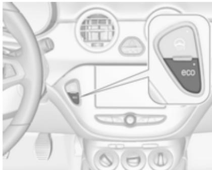
Desactive manualmente el sistema stop-start pulsando **eco**. Para indicar la desactivación, se apaga el LED del botón.
