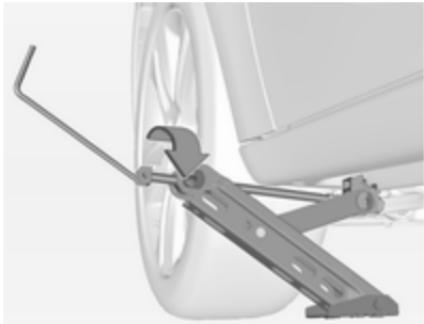
Acople la manivela del gato y, con el gato correctamente alineado, gire la manivela hasta que la rueda se despegue del suelo.
