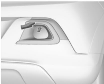
1. Extraiga la cubierta tirando con la mano en la posición marcada, consulte la flecha de la ilustración.
