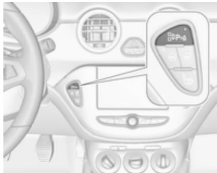
El asistente de aparcamiento delantero y trasero y el asistente de aparcamiento avanzado usan ambos el mismo botón para su activación y desactivación:
