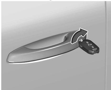
Die linke Vordertür durch Einsetzen und Drehen des Schlüssels im Schließzylinder von Hand verriegeln. Bei funktionsfähiger Zentralverriegelung wird das Fahrzeug verriegelt.
