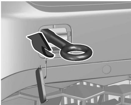
Abschleppöse bis zum Anschlag in waagerechter Stellung einschrauben. Die Abschleppstange an der Abschleppöse befestigen. Die Abschleppöse darf nur zum Abschleppen und nicht zum Bergen des Fahrzeugs verwendet werden. Die Zündung einschalten, um die Lenksperrung zu lösen und Bremsleuchten, Hupe und Scheibenwischer betätigen zu können.
