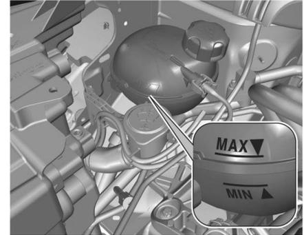
Liegt der Kühlmittelstand auf oder unter der MIN-Markierung, die Hilfe einer Werkstatt zum Auffüllen des Kühlmittels in Anspruch nehmen.
