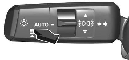
Durch Ziehen wird die Lichthupe aktiviert. Durch Ziehen wird das Fernlicht deaktiviert.
