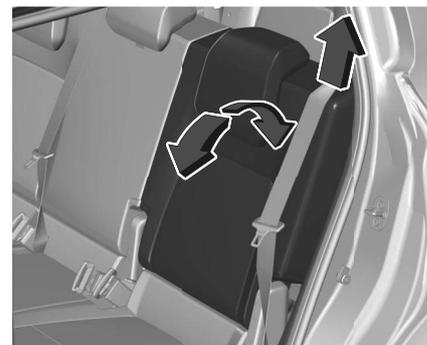
An der Schlaufe, die Neigung einstellen und lassen die Schlaufe loslassen. Zum Einstellen die Rückenlehne entlasten.
