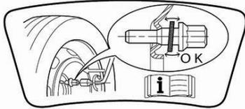
12. Die Radschrauben von Fahrzeugen mit Leichtmetallrädern können auch für das Stahl-Reserverad verwendet werden. Dann wird das Reserverad durch den konischen Kontakt der einzelnen Schrauben gesichert.
