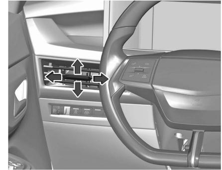
Richtung des Luftstroms durch Kippen und Schwenken der Lamellen einstellen. Zum Schließen der Belüftungsdüse die Lamellen nach außen schwenken.
