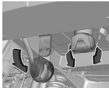
Den Anschlussstutzen nach unten schwenken. Den Verschlussstopfen aus der Öffnung für die Kugelstange der Kupplung entfernen und verstauen.
