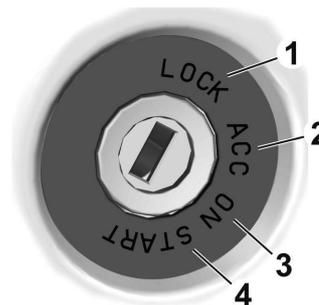
Den Schlüssel in Stellung 3 drehen, um die Lenkradsperrung freizugeben. Automatikgetriebe: Bremspedal betätigen.
