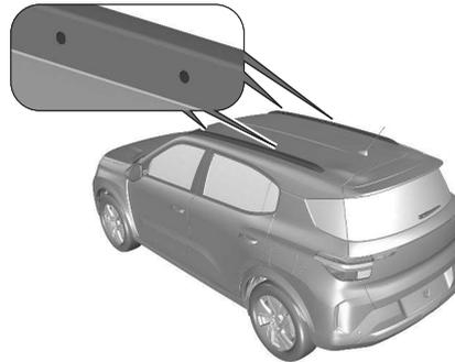
Markierungen an den Handläufen zeigen an, wo der Dachgepäckträger zu montieren ist.
