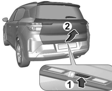
1. Die Heckklappen-Taste drücken.
