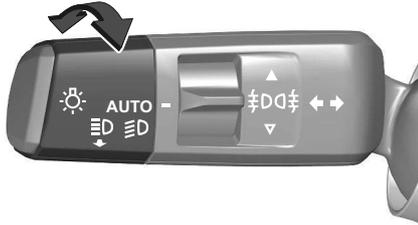
Bei aktivierter automatischer Lichtsteuerung schaltet das System abhängig von den äußeren Lichtverhältnissen und den Informationen des Wischersystems automatisch zwischen Tagfahrlicht und Scheinwerfern um.
