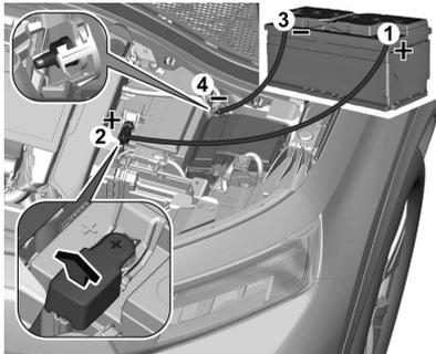
Die Schutzkappen der Pluspole beider Fahrzeugbatterien öffnen.
