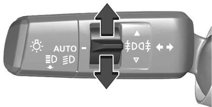
Den Schalter zweimal nach oben drücken, um die Nebelschlussleuchte einzuschalten.
