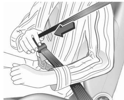
Den Sicherheitsgurt aus dem Aufroller herausziehen, unverdreht über den Körper führen und die Schlosszunge in das Gurtschloss einstecken, bis sie einrastet. Sicherstellen, dass der Sicherheitsgurt über die Schulter verläuft und während der Fahrt eng am Körper anliegt.
