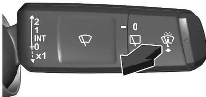
Ziehen Sie den Scheibenwischerhebel bis zum Anschlag zu sich heran.
