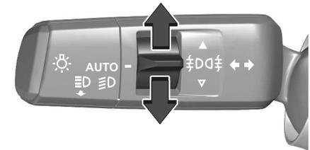
Den Schalter nach oben drücken, um die Nebelschlussleuchte einzuschalten. Den Schalter nach unten drücken, um die Nebelschlussleuchte auszuschalten.
