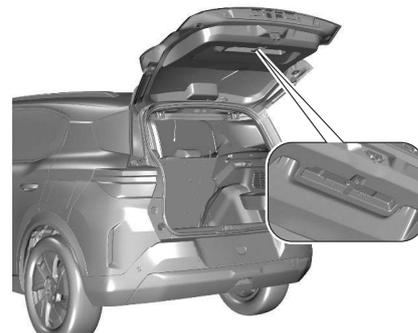
Warndreieck im Fach hinter der Heckklappe verstauen und mit dem Klettband Velcro® sichern.
