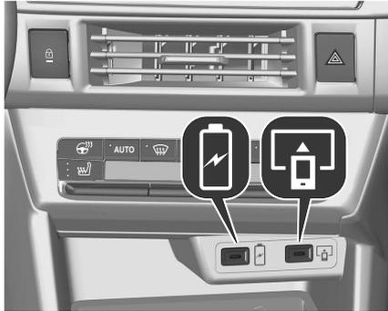
Diese Symbole bestimmen die Art der Verwendung eines USB-Anschlusses:
