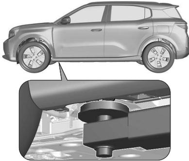
Die Position der vorderen Arme der Hebebühne befindet sich
