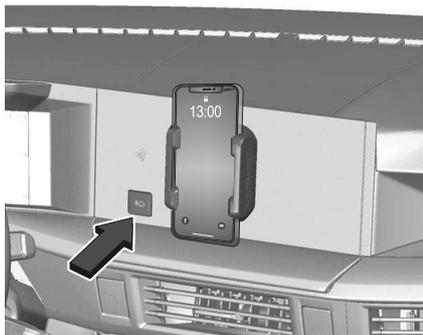
Die Bluetooth-Taste der Smartphone-Station drücken, damit die Bluetooth-Funktion sichtbar wird.
