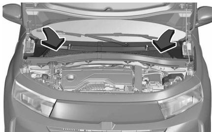
Der Lufteinlass im Motorraum außen vor der Windschutzscheibe muss zur Luftzufuhr frei sein. Gegebenenfalls Laub, Schmutz oder Schnee entfernen.
