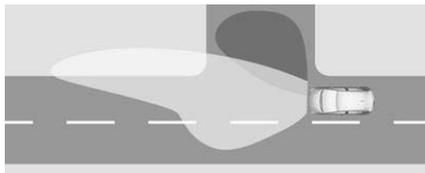
Beim Abbiegen werden je nach Lenkwinkel und Abbiegelicht bestimmte LEDs angesteuert, die die Fahrtrichtung beleuchten. Es ist bis zu einer Geschwindigkeit von 40 km/h aktiv.
