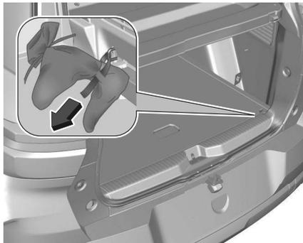
Die Tasche mit der Kugelstange wird auf der hinteren Bodenabdeckung im Laderaum verstaut.
