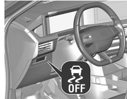
ESC und Antischlupfregelung (ASR) können bei Bedarf deaktiviert werden:
