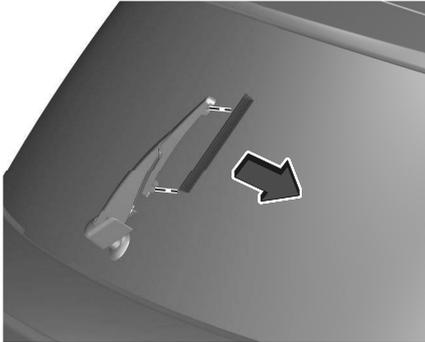
Wischerarm anheben. Wischerblatt wie in der Abbildung gezeigt ausrasten und abnehmen. Wischerblatt leicht abgewinkelt am Wischerarm ansetzen und drücken, bis es einrastet. Wischerarm vorsichtig absenken.
