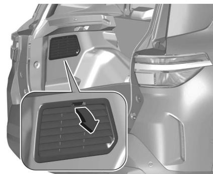
Klappen Sie die Abdeckung auf der linken Seite des Laderaums herunter. Verstauen Sie den Verbandskasten im Staufach.
