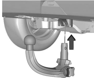
Die gespannte Kugelstange in die Öffnung einsetzen und fest nach oben drücken, bis sie hörbar einrastet. Der Drehgriff schnappt in seine ursprüngliche Position zurück und liegt ohne Spalt an der Kugelstange an.
