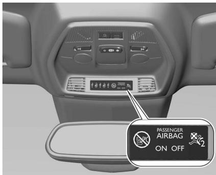
Wenn die Kontrollleuchte ON nach Einschalten der Zündung für ca. 60 Sekunden aufleuchtet, löst der Beifahrer-Airbag bei einem Unfall aus.
