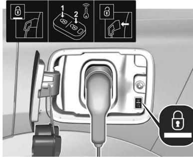
Nach dem Beginn des Ladevorgangs wird der Fahrzeugstecker am Ladeanschluss verriegelt und kann während des aktiven Ladens nicht getrennt werden.
