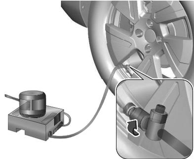
8. Den Einfüllschlauch am Reifenventil anschrauben.
