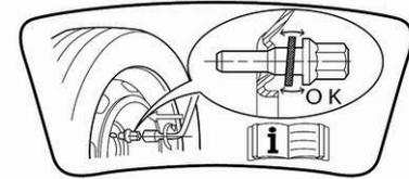
Bei den Radschrauben für Leichtmetallfelgen wird das Reserverad durch den konischen Kontakt der einzelnen Schrauben gesichert. In diesem Fall berühren die Unterlegscheiben das Reserverad nicht.
