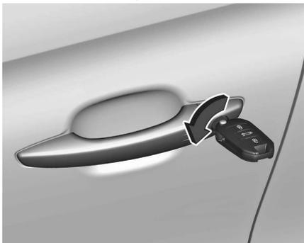
Die linke Tür durch Einsetzen und Drehen des Schlüssels im Schließzylinder entgegen den Uhrzeigersinn von Hand entriegeln. Durch Einschalten der Zündung wird die Diebstahlsicherung deaktiviert. Die anderen Türen können durch Ziehen am Innengriff geöffnet werden. Der Laderaum und die Tankklappe werden möglicherweise nicht entriegelt.
