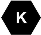
FF-Stecker bzw. -Anschluss zum Laden mit Gleichstrom
