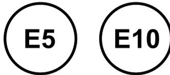
Nur bleifreie Kraftstoffe verwenden, die der Europäischen Norm EN 228, DIN 51626-1 oder einer gleichwertigen Spezifikation entsprechen.
