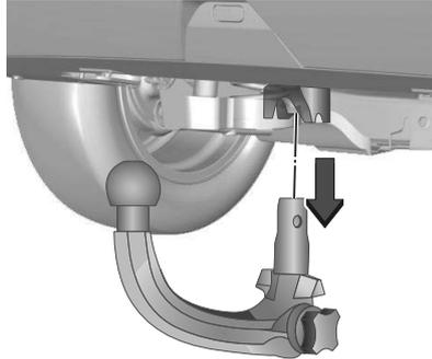
Die Schutzklappe öffnen und den Schlüssel in die Entriegelungsposition drehen, um die Kugelstange zu entriegeln.
