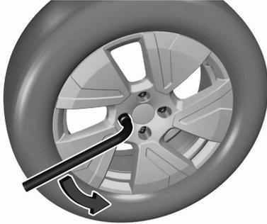
2. Radschlüssel anbringen und jede Radschraube um eine halbe Umdrehung lockern.
