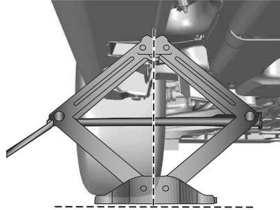
3. Sicherstellen, dass der Wagenheber richtig unter dem entsprechenden Aufnahmepunkt ausgerichtet ist.
