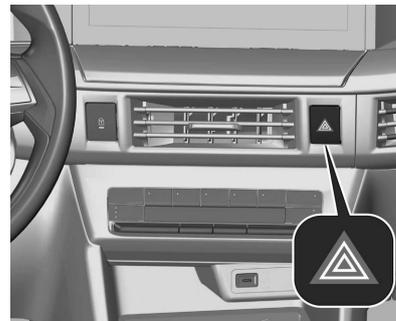
Die Taste zur Aktivierung drücken. Bei einer Notbremse mit starker Bremsenbetätigung wird automatisch der Warnblinker aktiviert. Sobald das Fahrzeug wieder beschleunigt wird, wird der Warnblinker automatisch ausgeschaltet.
