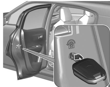
Rote Kindersicherung in den hinteren Türen mit einem Schlüssel in Richtung Fahrzeuginnenraum in die waagerechte Stellung drehen. Die Tür lässt sich dann von innen nicht öffnen. Zum Deaktivieren die Kindersicherung wieder senkrecht stellen.
