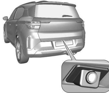
Die Rückfahrkamera unterstützt den Fahrer beim Rückwärtsfahren, indem sie auf dem Display eine Ansicht des Bereichs hinter dem Fahrzeug anzeigt. Das System kann beinahe eine 135°-Ansicht der Fahrzeugumgebung im Informationsdisplay anzeigen.
