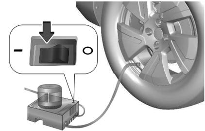
11. Wippschalter auf dem Kompressor auf **I** stellen. Der Reifen wird mit Dichtmittel gefüllt.
