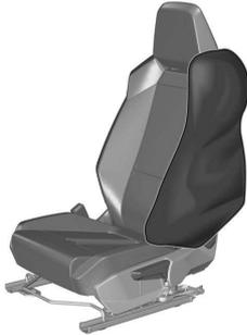
Der aufgeblähte Airbag dämpft den Aufprall, wodurch die Verletzungsgefahr für Oberkörper und Becken bei einem Seitenaufprall deutlich verringert wird.
