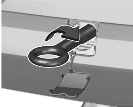
Einschrauben der Abschleppösebis zum Anschlag in waagerechter Stellung einschrauben.
