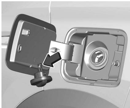
Der Deckel kann am Haken an der Tankklappe eingehängt werden. Die Tankdüse gerade am Einfüllstutzen ansetzen und mit geringem Kraftaufwand einstecken.
