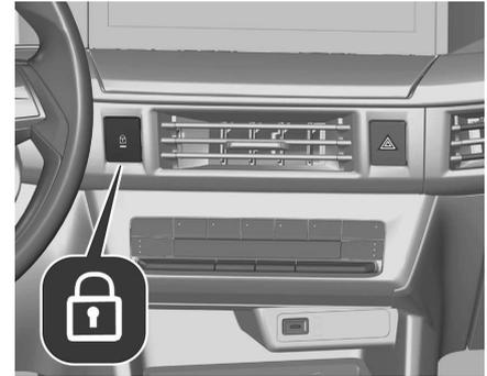
Bei eingeschalteter Zündung
