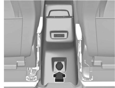
Ein Zubehörteil mit 12 V-Betriebsspannung (mit einer maximalen Leistung von 120 W) mit einem geeigneten Adapter anschließen. Berücksichtigen Sie die Angabe zur maximalen Leistung, um das Zubehör nicht zu beschädigen.
