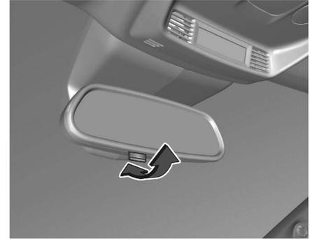
Zur Reduzierung der Blendwirkung, den Hebel an der Unterseite des Spiegelgehäuses ziehen.
