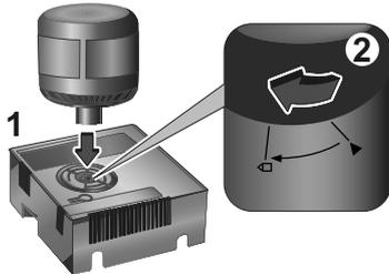
5. Zunächst die Flasche mit dem Dichtmittel in den Kompressor
