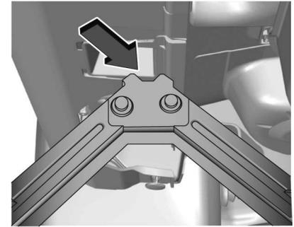
5. Sicherstellen, dass die Karosseriekante in der Kerbe am Wagenheber sitzt.
