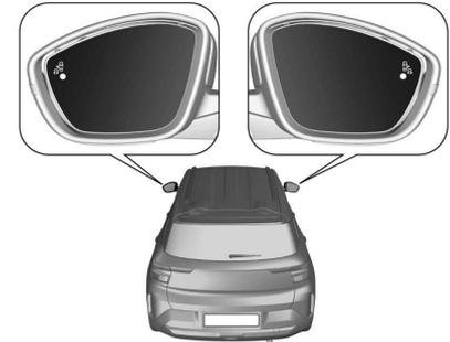
Erkennt das System bei Vorwärtsfahrt ein Fahrzeug im toten Winkel, leuchtet im entsprechenden Seitenspiegel eine LED auf. Wenn die Blinker auf der entsprechenden Seite aktiviert sind, blinkt die LED.
