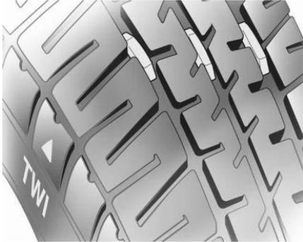
Die gesetzlich zulässige Mindestprofiltiefe (1,6 mm) ist erreicht, wenn das Profil bis zu einem Verschleißanzeiger (TWI = Tread Wear Indicator) abgefahren ist. Seine Lage wird durch Markierungen an der Reifenflanke angezeigt. Sollte der Verschleiß vorn größer sein als hinten, Vorderräder regelmäßig gegen Hinterräder tauschen. Wenn Reifen mit
