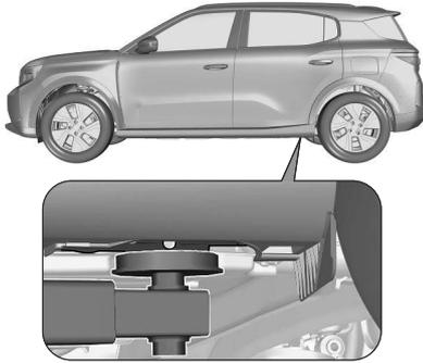
Die Position der hinteren Arme der Hebebühne befindet sich mittig unter den entsprechenden Wagenheberaufnahmen.
