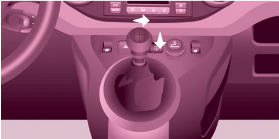
Cutia de viteze cu 5 trepte - mers inapoi
