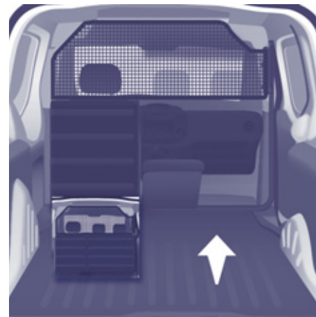
Perete separator cu trapă
