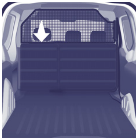
Perete separator semi-înălțime
