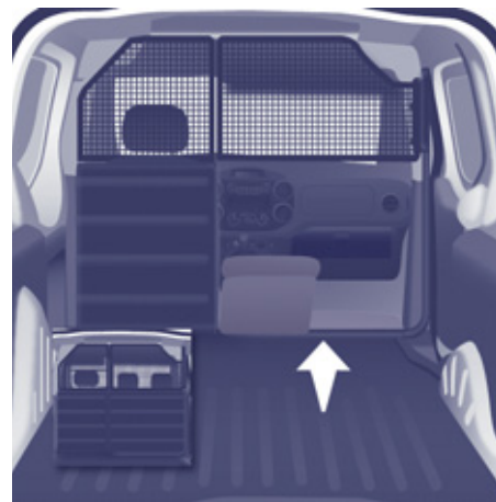
Perete separator cu trapă
