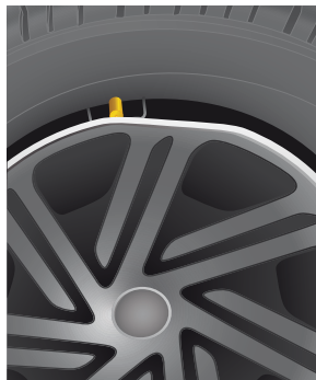
Из-за неправильной установки на диск край колпака возле вентиль перекосился.
