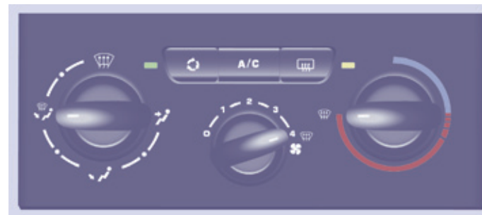
Panou aer condiționat
