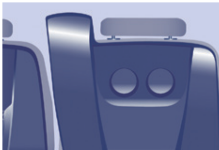
Oparcia foteli środkowych są wyprofilowane i posiadają wytłoczenia na kubki i schowki.
