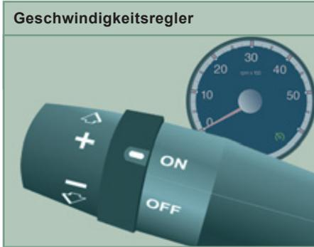
Die Geschwindigkeitsregelung wird über eine Kontrollleuchte im Drehzahlmesser im Kombiinstrument angezeigt.
