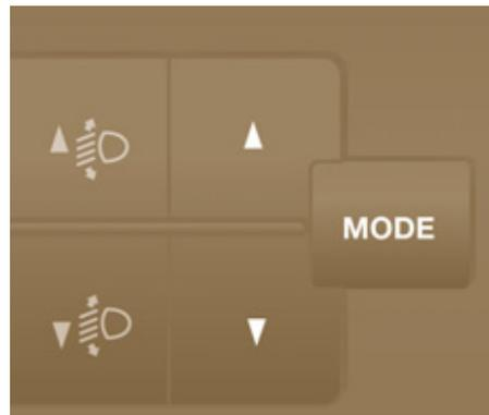
Wenn Ihr Fahrzeug mit der Funktion zur Inaktivierung des Beifahrerairbags ausgerüstet ist, muss sie über die Taste MODE des Bordcomputers angewählt werden.
