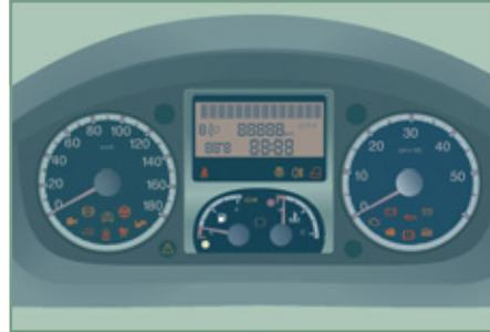
Bei eingeschalteter Zündung leuchten die orangefarbenen und roten Warnleuchten auf. Bei laufendem Motor müssen diese Leuchten erlöschen. Wenn sie weiterhin leuchten, schauen Sie im betreffenden Teil nach.
