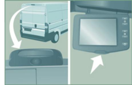
Die Kamera wird beim Einlegen des Rückwärtsgangs eingeschaltet und bleibt bis zu einer Geschwindigkeit von etwa 15 km/h aktiviert. Ab 18 km/h wird sie deaktiviert.
