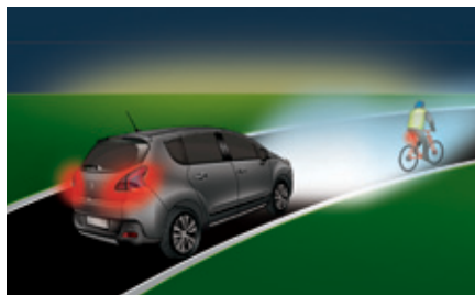
z reflektorami kierunkowymi
