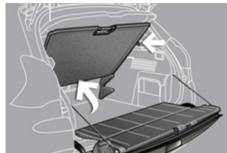
Din poziția înaltă, plasați placa în această poziție (pe diagonală), ținând cele două capete pentru a accede în partea inferioară sau la roata de rezervă.
