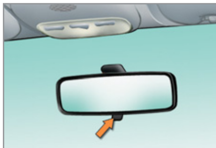
Зеркало с ручной регулировкой режима "день/ночь"
