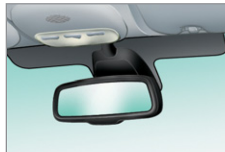
Зеркало заднего вида с автоматической регулировкой "день"/"ночь"
