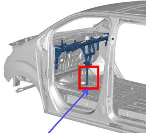
2/ Jambe de force: sous la console centrale, offre une résistance à Césariser pour la bascule du bloc avant
