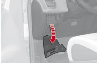
Nach allen Arbeiten an den Sicherungen darauf achten, dass der Deckel wieder korrekt angebracht wird, damit die Dichtheit des Sicherungskastens gewährleistet ist.
