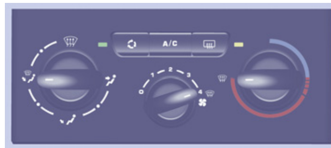
Panou aer condiționat
