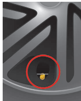
Poziție incorectă a valvei: sub inel.
