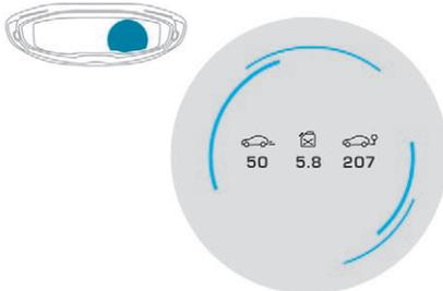
Je nach Ausführung werden bei Auswahl des Anzeigemodus „BORDCOMPUTER“ oder „PERSÖNLICH“ dauerhaft die Daten des Bordcomputers angezeigt. In allen anderen Anzeigemodi werden die Daten durch Drücken des Knopfes am Ende des Scheibenwischerhebels in einem speziellen Fenster vorübergehend angezeigt.
