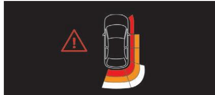
Mit vier zusätzlichen Sensoren an den Seiten am vorderen und am hinteren Stoßfänger erfasst das System die Position von feststehenden Hindernissen während des Manövers und signalisiert sie, wenn sie sich neben den Seiten des Fahrzeugs befinden.
