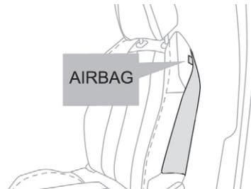
Dieses System bietet Fahrer und Beifahrer bei einem starken Seitenaufprall Schutz und soll die Verletzungsgefahr im Brustbereich sowie zwischen Hüfte und Schulter einschränken. Jeder Seiten-Airbag ist in das Sitzlehngestell an der Türseite integriert.
