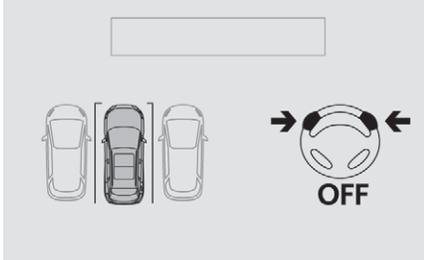
Nach Beendigung des Einparkvorgangs erlischt die Kontrollleuchte auf dem Kombiinstrument, in Verbindung mit der Anzeige einer Meldung und einem akustischen Signal. Die Unterstützung ist deaktiviert: Sie können das Steuer wieder übernehmen.
