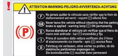
Bitte stellen Sie vor Verlassen des Fahrzeugs sicher, dass die Feststellbremse angezogen ist: Die Kontrollleuchten müssen auf dem Kombiinstrument und am Betätigungsschalter ununterbrochen leuchten.
